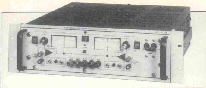
Schon die Frontplatte verdeutlicht die Arbeitsweise des BOP 50-8M von Kepco. Das Gerät arbeitet wie ein bipolarer DC-Leistungsoperationsverstärker.
